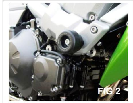
Avvitare direttamente il paratelaio utilizzando la vite lunga 100mm e relativo distanziale alto 19mm.
