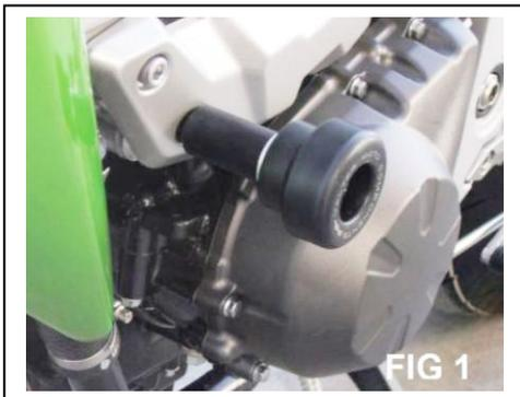
Avvitare direttamente il paratelaio utilizzando la vite 110mm e relativo distanziale 45mm.
