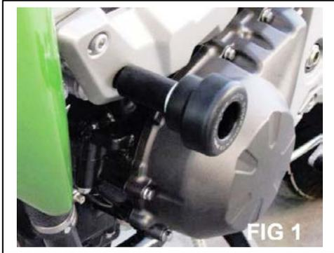
Avvitare direttamente il paratelaio utilizzando la vite 110mm e relativo distanziale 45mm.
