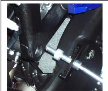
Avvitare la piastra paratelaio interponendo il distanziale alto 10.5mm. Avvitare il pomolo tramite la relativa vite (10x80mm) e il distanziale alto 42mm FIG. 2 e FIG. 3
