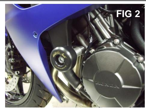
Svitare la vite supporto motore, sostituire il distanziale standard con la piastra VMC.
