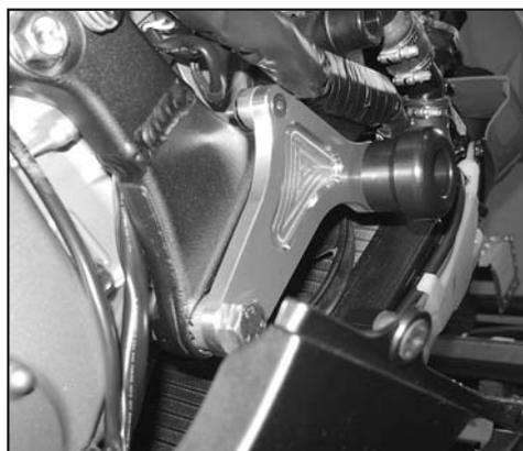
Fissare come mostrato in figura la piastra col paratelaio al telaio della moto.
