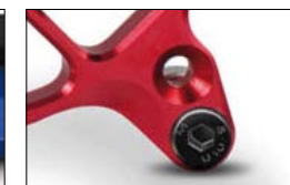
Two positions for shifting shaft Leva cambio 2 posizioni per asta cambio
