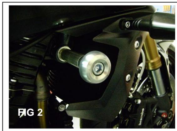
Svitare la vite di ancoraggio motore/testata anteriore al telaio.
