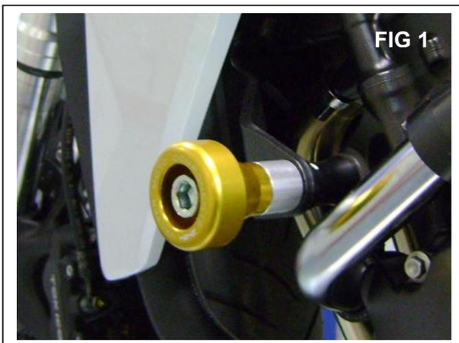
Svitare la vite di fissaggio del motore al telaio.
