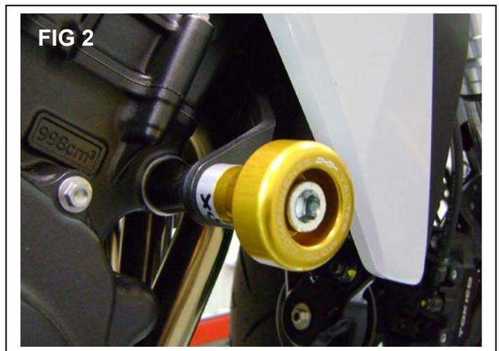
Svitare la vite di fissaggio del motore al telaio.
