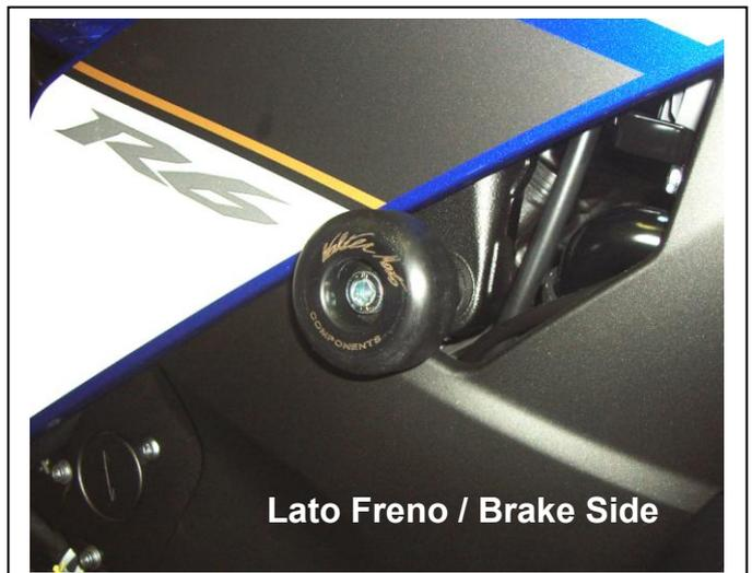
Svitare le viti supporto motore e fissare i parateli VMC con i distanziali posizionati come in figura.
