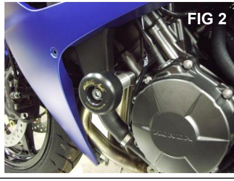
Svitare la vite supporto motore, sostituire il distanziale standard con la piastra VMC.
