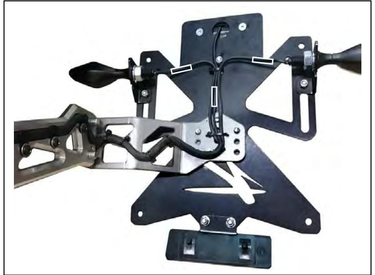
**2** Montare il portatarga assemblato all'attacco tendicatena "B" e disporre il cablaggio facendogli seguire il percorso del filo sensore ABS bloccandolo con le fascette. Far passare il cablaggio all'interno del vano sottosella portandolo in prossimità dei connettori.
