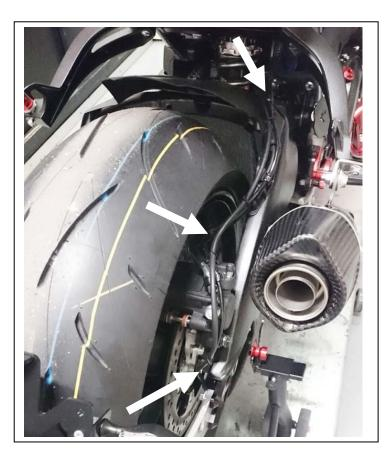
Montare il portatarga assemblato all'attacco tendicatena "B" e disporre il cablaggio facendogli seguire il percorso del filo sensore ABS bloccandolo con le fascette.
