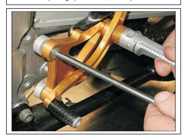
Far passare l'asta cambio all'interno del telaio e regolare la posizione della leva, come mostrato.
