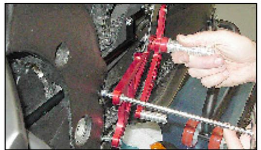
6 Regolare la posizione della leva. **NB.** Al fine di ottimizzare la precisione del cambio montare la bielletta in modo da formare un angolo retto con l'asta del cambio.
