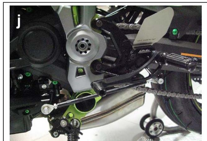
j) Regolare infine l'altezza della leva del cambio ruotando l'asta di rinvio
