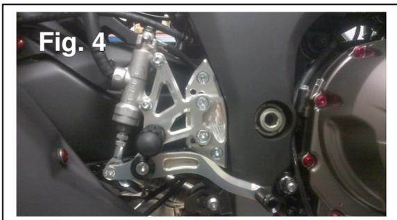
Montare l'assieme pedana sul telaio come da FIG.4
