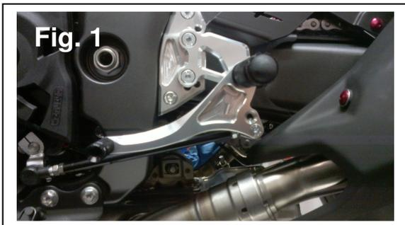
Montare l'assieme pedana sul telaio come da FIG.1
