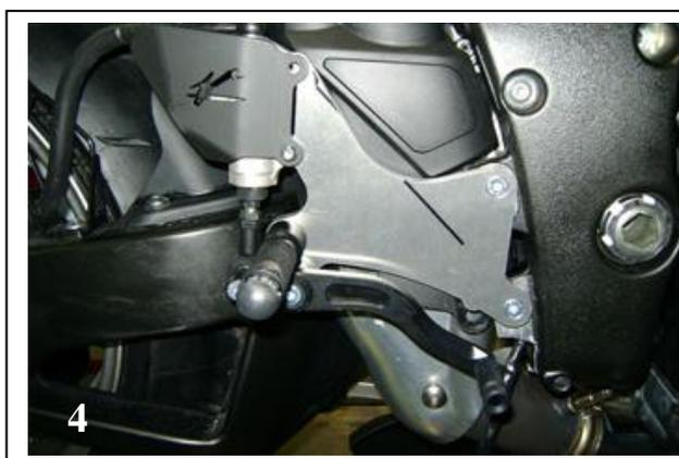
**4** Avvitare la pompa freno post. alla pedana VMC (2 viti 6 x20), collegare la stessa alla leva freno tramite l'uniball in dotazione e il relativo distanziale alto 18 mm.
