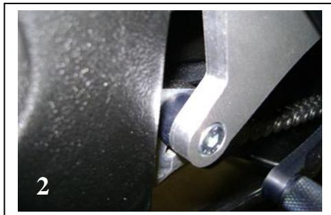
**2** Fissare la bielletta VMC all'albero preselettore cambio (FIG 3), nel caso si voglia usare il cambio rovesciato, ruotare di 180° la bielletta.
