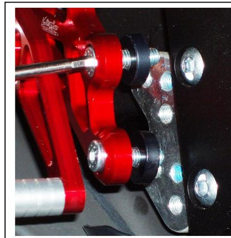
5 Avvitare la leva all'uniball utilizzando la vite e il distanziale forniti.
