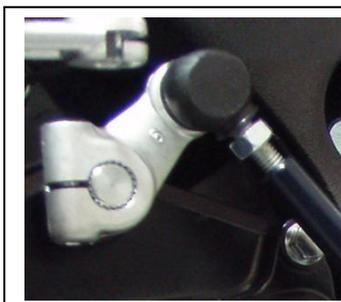
3 Posizionare bielletta opzionale per cambio rovesciato. Regolare la posizione della leva.
